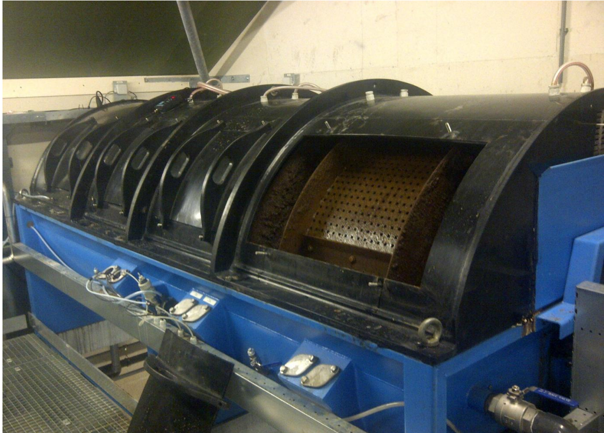
Figuur 3. Biorotor voor het OLAND proces
